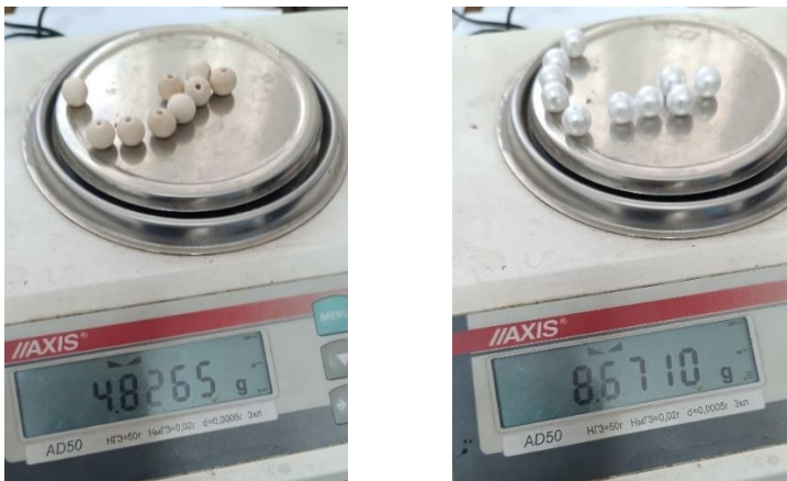
Рисунок 2 – Зважування полістерольних (ліворуч) і дерев'яних (праворуч) кульок.
