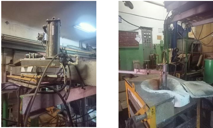
Рисунок 3 – Лабораторне обладнання для «гарячого» моделювання комплексної обробки чавуну.
