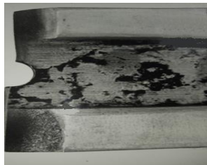
Рисунок 4 – Осповидний знос на робочій дорожці опорної планки.
