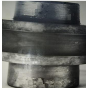
Рисунок 2 – Викришування цапф роликів станів ХПТР.
