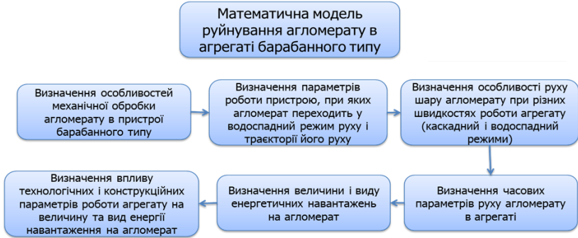
Рисунок 3 – Структура моделі руйнування агломерату в агрегаті барабанного типу.
