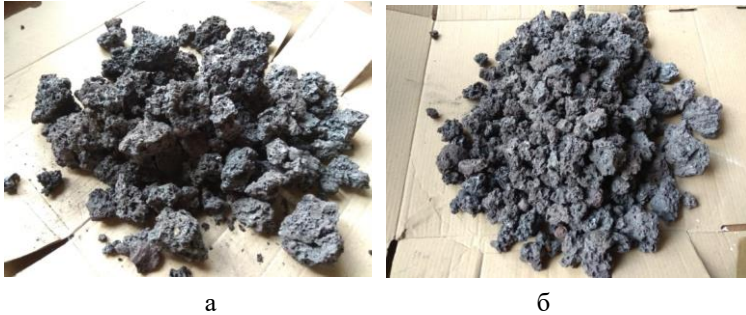
Рисунок 7 – Вид агломерату до (а) та після (б) механічної обробки в дослідному барабані.
