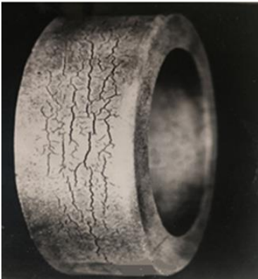
Рисунок 2 – Розгарні тріщини на поверхні матричного кільця.
