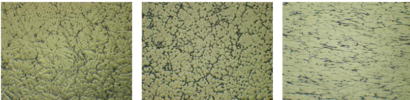
Рисунок 1 – Мікроструктура сплавів системи Al-6Mg-0,3Sc-0,1Zr:
