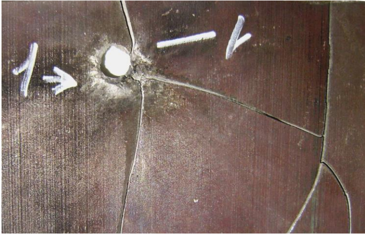
Рисунок 7 - Фото фрагменту з дослідної пластини № 1 розміром \approx 220 \times 220 мм товщиною 6,8 мм зі сталі 38ХНЗМФА після випробування бронебіійно-запалювальною кулею 7,62 мм x 54 мм (7.62 x54R) із термозміцненим осередям у сталевій оболонці (Б32 7-Б3-323) з гвинтівочним патроном на відповідність 6 класу захисту за ДСТУ 8782:2018 (п. 5.2.1, табл. 1) для бронежилетів зовнішнього носіння (тип 1).
