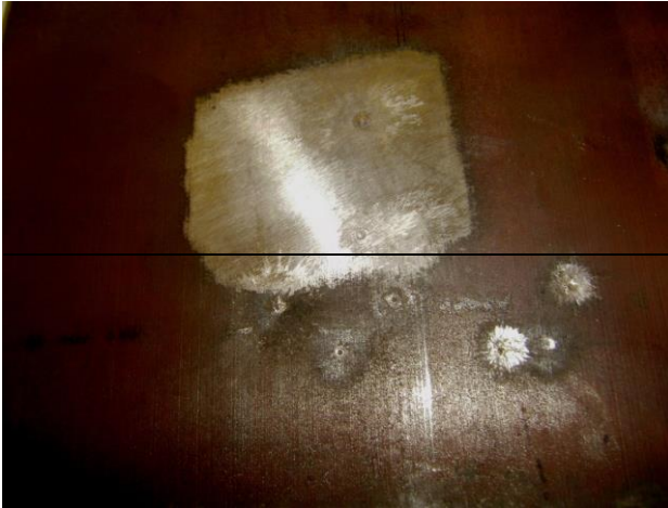
Рисунок 5, 6 – Фото фрагменту дослідної сталевієї пластини розміром 220 x 220 мм товщиною 6,8 мм зі сталі 0ХНЗМФ (лицьова площина – місця зіткнення пуль з металом пластини)
