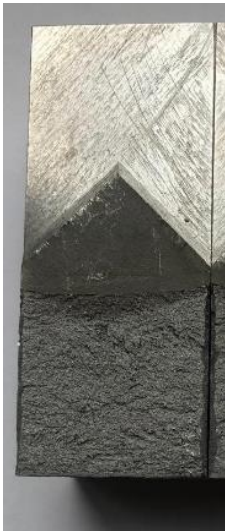
Плавка № 21745 без мікролегуння, подвійна термообробка, в'язкість руйнування K_{IC} 60,2 МПа·м 1/2
