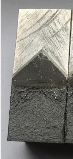
Плавка №2, мікролегована ванадієм, подвійна термообробка, в'язкість руйнування K_{IC} 110,9 МПа·м 1/2
