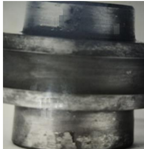
Рисунок 2 – Викришування цапф роликів станів ХПТР.
