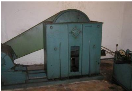
Рисунок 1 – Загальний вигляд випробувального стенду «485 Рч» для моделювання екстреного гальмування в парі «колесо-рейка» та зразка.
