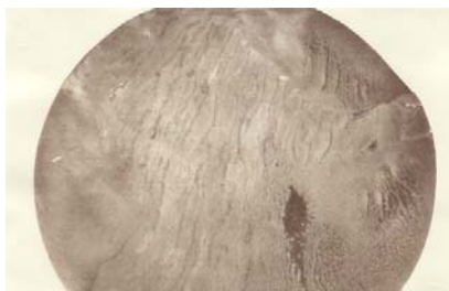
Рис.3. Поперечный излом дорна 215/216 мм из стали 25Х2М1Ф (×1).
