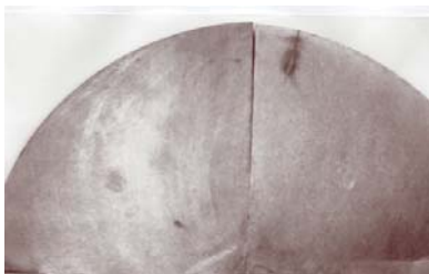
Рис.1 Макроструктура дорновой заготовки из стали 35ХМ ( \times 1 ).
