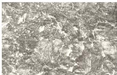
Рис.2. Микроструктура металла дорновой заготовки из стали 35ХМ ( \times 500 ).
