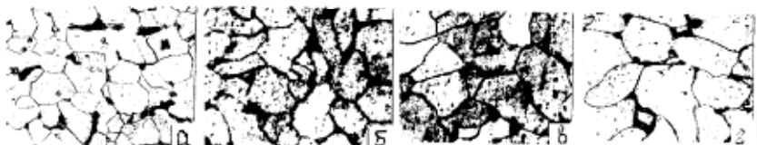
Рис. 2. Влияние температуры окончания прокатки ( a – 950°С, б – 700°С, в – 600°С, г – 500°С) при высокотемпературном нагреве (1000°С) на микроструктуру горячекатаной особотонкой листовой стали 08пс
