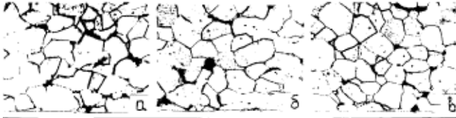
Рис. 3. Влияние температуры прокатки (а – 700°C, б – 600°C, в – 500°C) при низкотемпературном нагреве на микроструктуру горячекатаной особотонкой листовой стали 08пс
