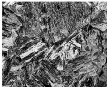
Рис.1 Диаграмма распада аустенита стали Ст3 при содержании углерода на нижнем марочном пределе и микроструктура образцов, \times 1000 ; скорости охлаждения после деформации:
