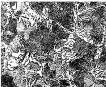
Рис.1 Диаграмма распада аустенита стали Ст3 при содержании углерода на нижнем марочном пределе и микроструктура образцов, \times 1000 ; скорости охлаждения после деформации:
