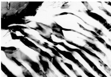
Рис. 1а Структура стали 09Г2ФБ после контролируемой прокатки при 740 °С (разветвление пластин цементита с изменением плоскости габитуса x30 000)
