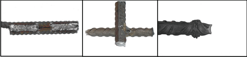
Рис.1. Общий вид исследуемых сварных соединений: слева направо – нахлесточное, крестообразное, стыковое.
