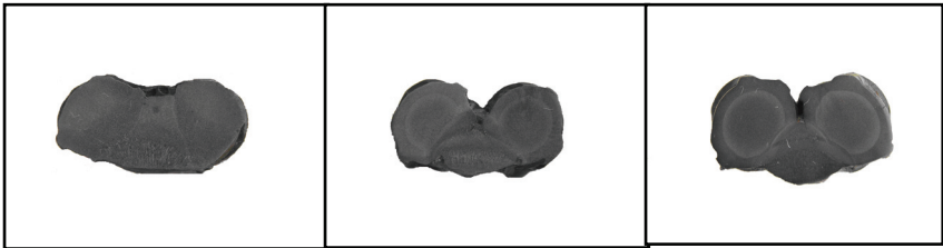
Рис. 2. Макроструктура сварного нахлесточного соединения, полученного электродуговой: слева направо – ручной сваркой, полуавтоматической (MAG 1-й режим), полуавтоматической (MAG 2-й режим) сваркой.
