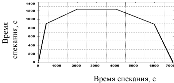
Рисунок 13 – Режим спекания прокатанной титановой пластины
