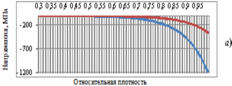
Рисунок 2 – Напряжения в порошке титана при экспериментах на гидростатическое (а) [4] и одноосное (б) [5] сжатия как функции от относительной плотности
